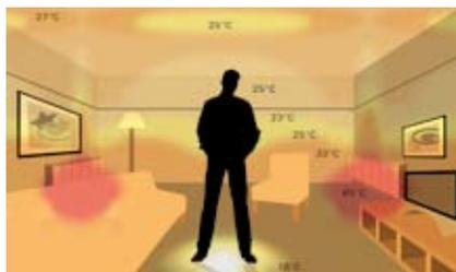
Распределение тепла в комнате при использовании радиаторов. Характеризуется значительным разбросом температур в помещении (18–25°C).
