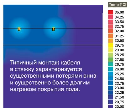
Греющий кабель, уложенный в стяжку на бетонном основании.
